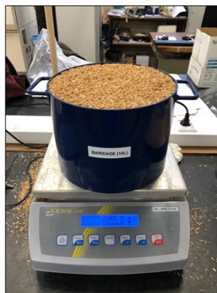
Figura 3.1 - Ensaio de baridade aplicado à casca de arroz
