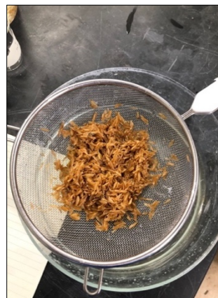
Figura 3.7 - Processo de escorrimento da água existente na superfície da casca de arroz.
