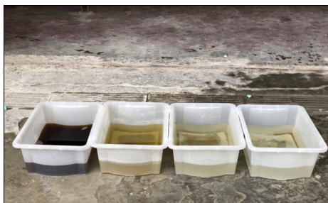
Figura 3.22 - Diferença na coloração dos lixiviados, durante o processo de neutralização.
