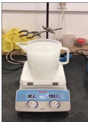
Figura 3.18 - Diluição do hidróxido de sódio, com recurso ao agitador magnético.
