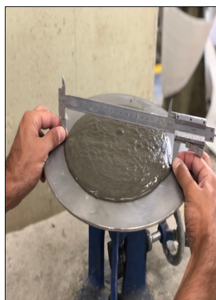
Figura 3.25 - Processo de aferição do diâmetro médio da pasta.
