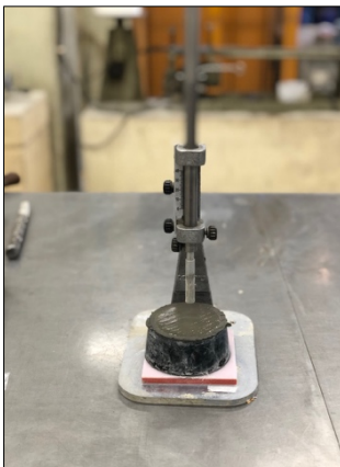
Figura 3.26 - Aparelho de Vicat e sonda utilizados na determinação da consistência normal da pasta.
