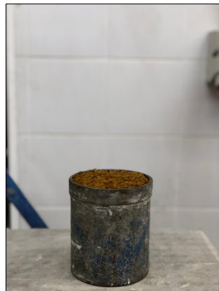
Figura 4.1 - Ensaio de baridade, aplicado à casca de arroz tratada com 3% de NaOH.
