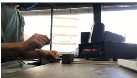
Figura 3.35 - Setup do ensaio de módulo de elasticidade dinâmico realizado.
