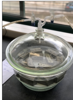
Figura 3.32 - Provetes no exsicador, imersos em água.
