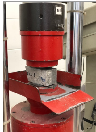
Figura 3.30 - Amostra de pasta a ser ensaiada à compressão.
