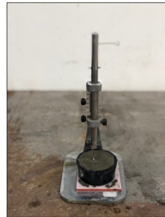
Figura 3.28 - Medições para determinação do início de presa.
