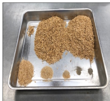
Figura 3.4 - Frações de material retidos em cada um dos peneiros.
