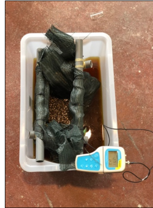
Figura 3.21 - Processo de aferição do valor de pH da solução resultante do tratamento da casca de arroz.
