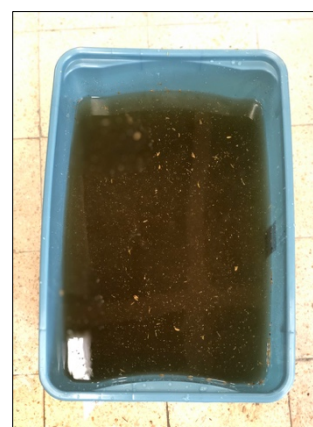
Figura 3.12 - Lixiviado resultante da imersão da casca de arroz, após 2h de imersão.
