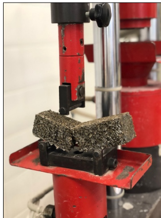
Figura 3.29 - Amostra de argamassa a ser ensaiada à flexão.
