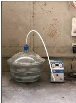
Figura 3.31 - Material utilizado para a execução do ensaio de porosidade.
