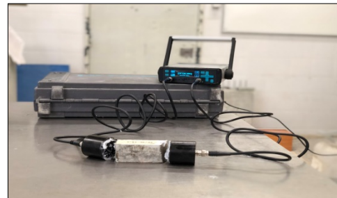
Figura 3.34 - Ensaio de ultrassons a um provete de pasta.
