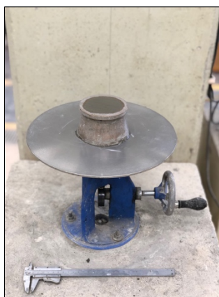
Figura 3.24 - Demonstração do molde totalmente preenchido e rasado, pela pasta a ensaiar.
