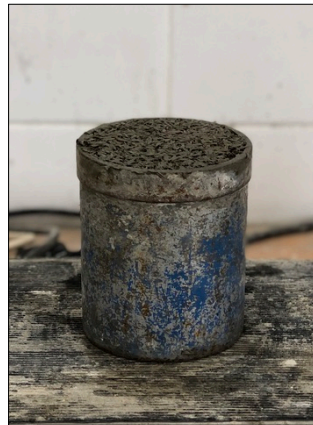
Figura 3.23 - Exemplo do copo de 1L, totalmente preenchido com argamassa e rasado no topo.
