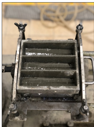
Figura 3.16 - Molde na mesa de compactação.
