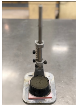
Figura 3.27 - Medições para determinação do fim de presa.
